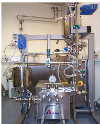
Slika 2.8. Homogenizatori srednjeg i velikog kapaciteta: (a) Micron LAB 60 (APV Deutschland GmbH, Unna, Nemačka); (b) APV Gaulin 5.5 (APV Deutschland GmbH, Unna, Nemačka)
