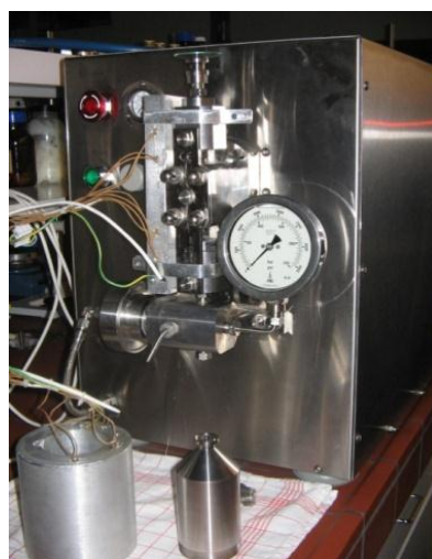
Slika 2.7. Lab-scale piston gap homogenizatori: (a) Micron LAB 40 ((APV Deutschland GmbH, Unna, Nemačka) i (b) EmulsiFlex C-3 (Avestin, Mannheim, Nemačka)
