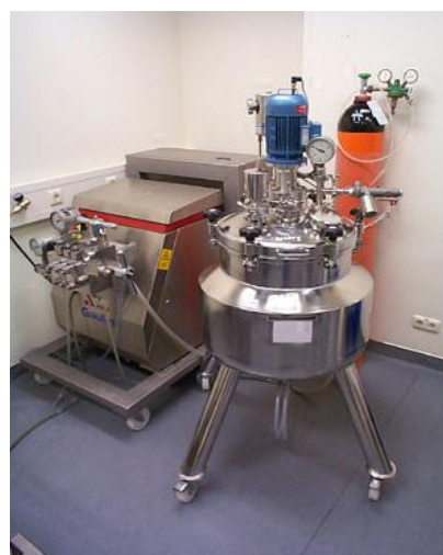
Slika 2.8. Homogenizatori srednjeg i velikog kapaciteta: (a) Micron LAB 60 (APV Deutschland GmbH, Unna, Nemačka); (b) APV Gaulin 5.5 (APV Deutschland GmbH, Unna, Nemačka)
