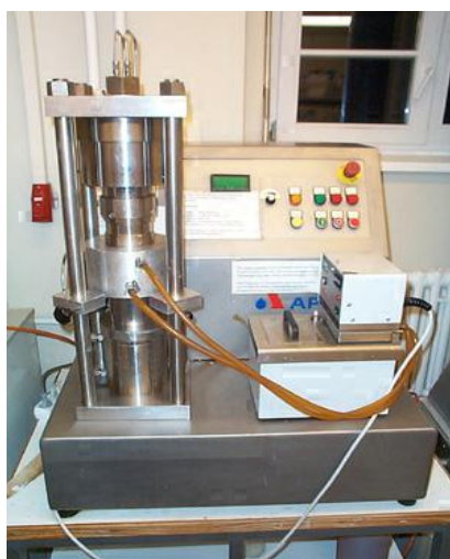
Slika 2.7. Lab-scale piston gap homogenizatori: (a) Micron LAB 40 ((APV Deutschland GmbH, Unna, Nemačka) i (b) EmulsiFlex C-3 (Avestin, Mannheim, Nemačka)
